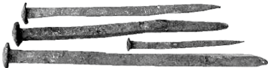
Servaas van den Brand, de plaatselijke smid, maakte de nagels, waarvan de langste 28 centimeter, en ander ijzerwerk voor herstel van de Pannenhoefsebrug en de Kerkvonder.
